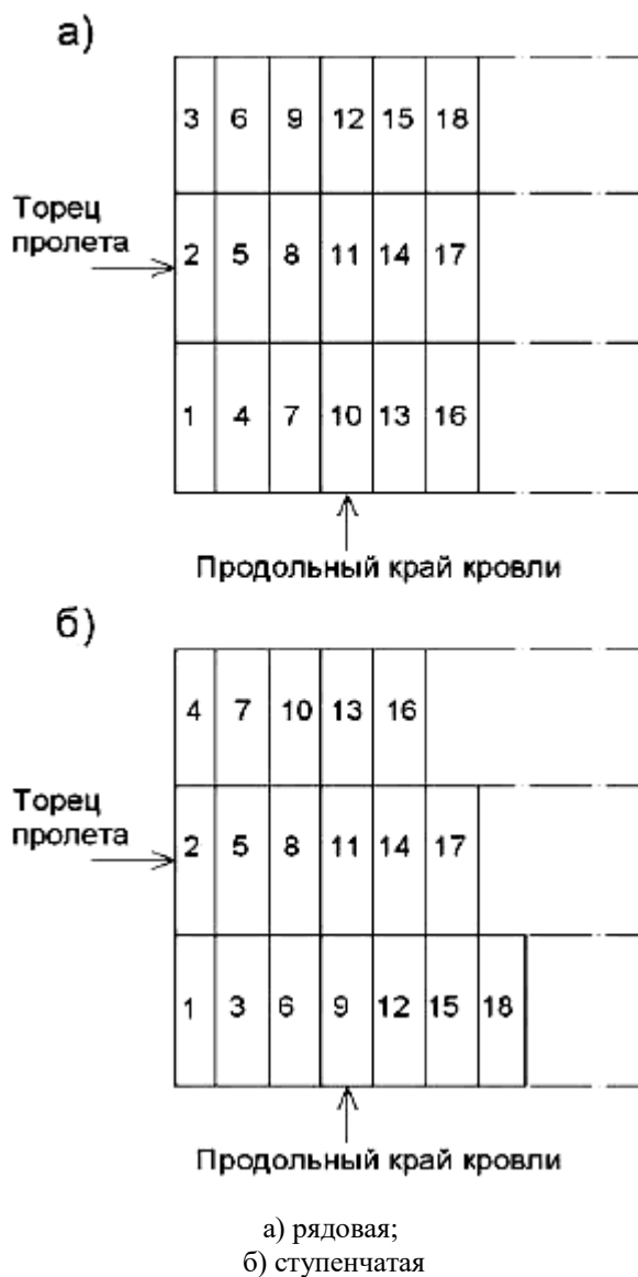
Рисунок 6 - Последовательность укладки настила
