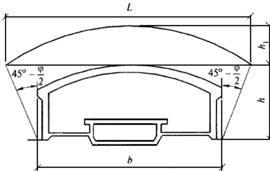
Рисунок 1 - Схема для расчета высоты свода обрушения
