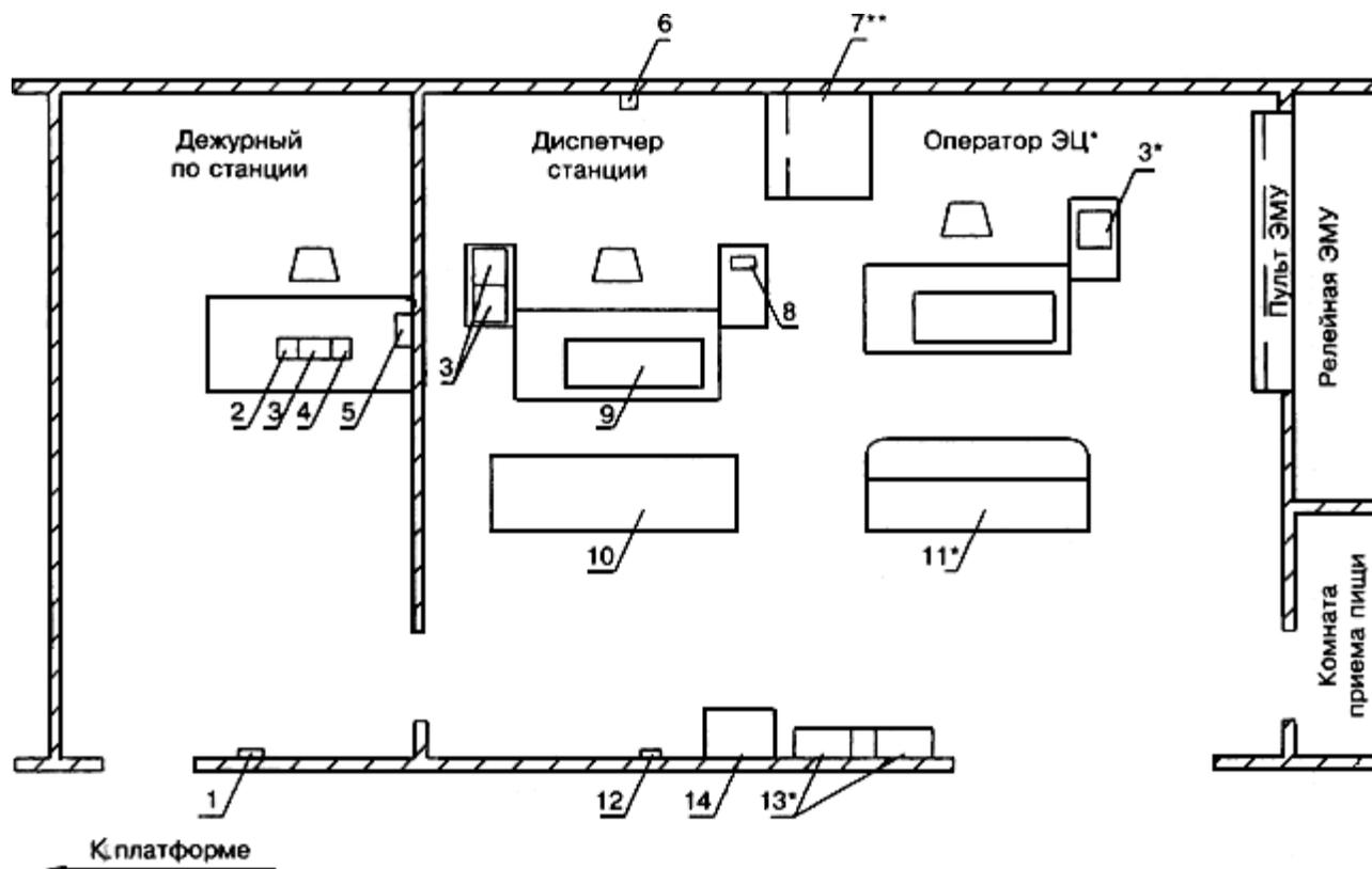
1 - часы электрические вторичные; 2 - абонентская установка связи; 3 - пульт связи; 4 - пульт связи дополнительный; 5 - коммутатор громкоговорящего оповещения; 6 - устройство
